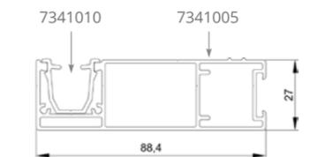
Standardmäßig eiseitige Führungsschienen zum ZF-A.
